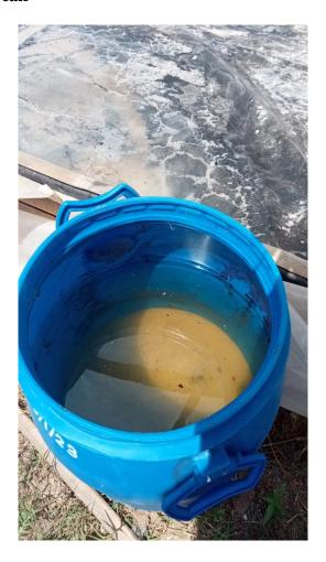
Limbah cair yang dihasilkan dari proses produksi garam adalah air bittern. Bittern merupakan produk samping dari produksi garam berupa larutan jenuh sisa hasil kristalisasi larutan garam (brine) baik yang dilakukan dengan penguapan sinar matahari ataupun dengan bantuan alat kristalisator. Bittern adalah cairan pekat yang diperoleh dari hasil limbah pabrik garam dan jumlahnya sangat melimpah. Bittern mengandung berbagai mineral, mineral ini terjadi karena tidak ikut mengkristal saat
